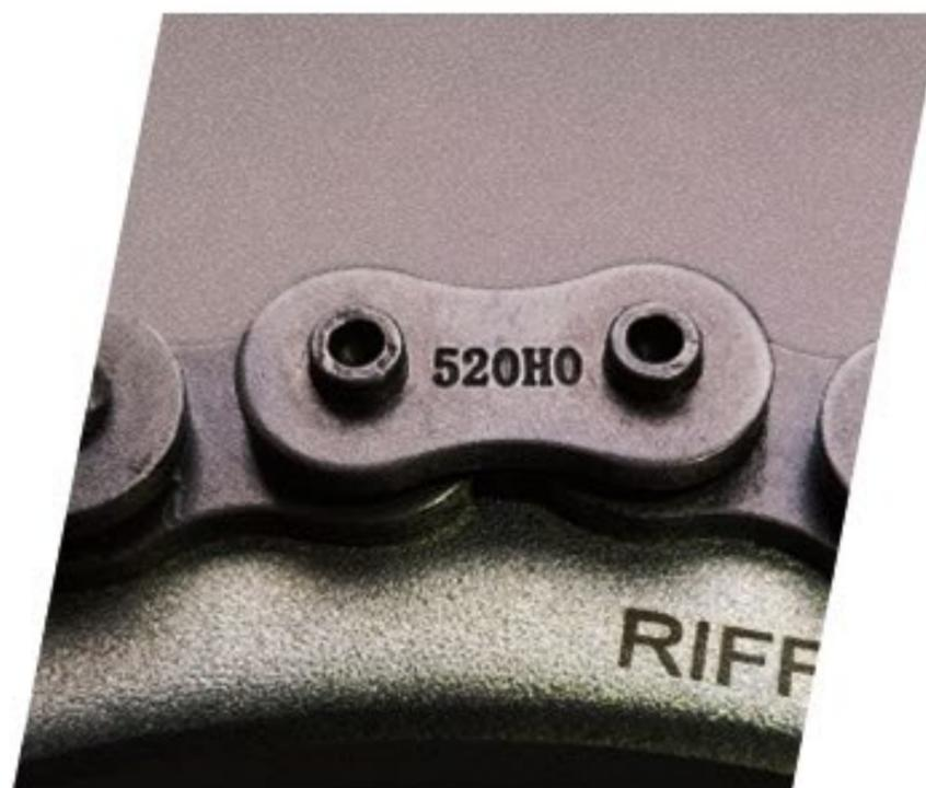
CON LAS PLACAS DE LA EMENDA PEGADAS A LOS O'RINGS, Y RESPETANDO LA HOLGURA (APROX. 1,5MM).
