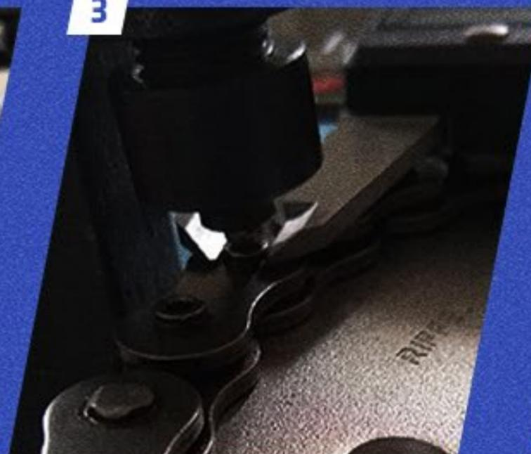
CHEQUEAR EL DIÁMETRO DURANTE EL REMACHE, EL DIÁMETRO DE LA PUNTA DEL PERNO DEBE AUMENTAR DE 3% A 5% DE LA MEDICIÓN INICIAL.
